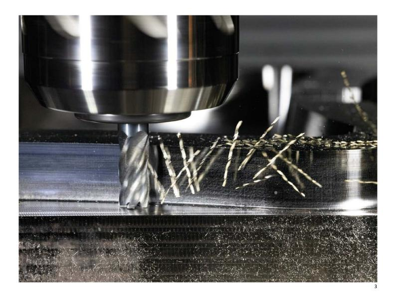
Stahl ist der gängigste Werkstoff im Werkzeug- und Formenbau. Es gibt jedoch viele Arten von Stählen und die ausgewählten Zerspanungswerkzeuge müssen für diese Varianten geeignet sein. Die wichtigsten Eigenschaften von Stahl sind Festigkeit, Verschleißfestigkeit, Korrosionsbeständigkeit, Härte, Bearbeitbarkeit, Polierbarkeit und Formbeständigkeit. Stahl kann in zwei Hauptgruppen unterteilt werden:
