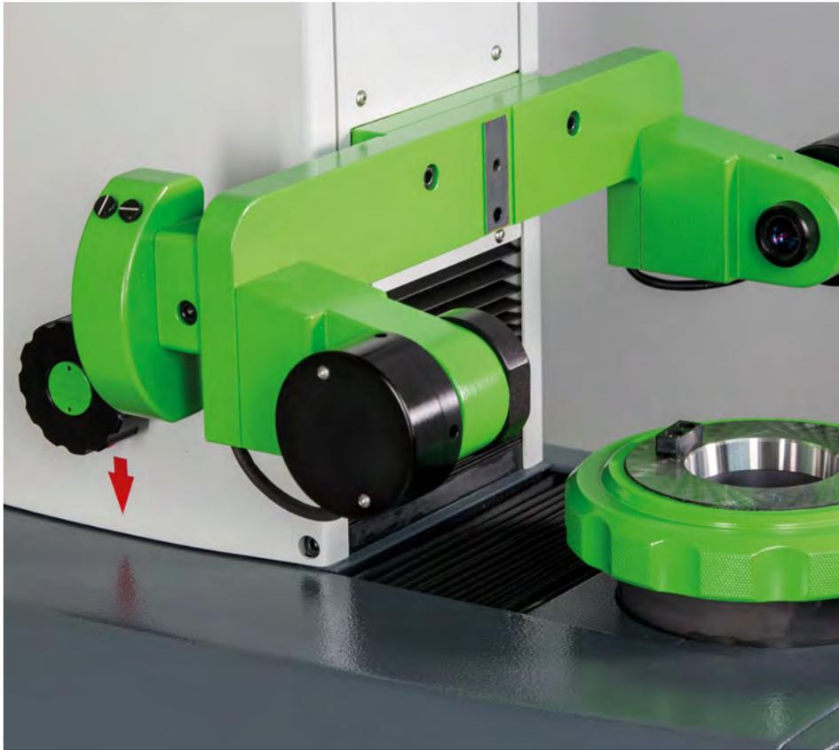
**Kamera:** Digitalkamera mit LED-Durch- und Auflichtbeleuchtung für genaue Messungen und kontrastreiche Schneideninspektion.
